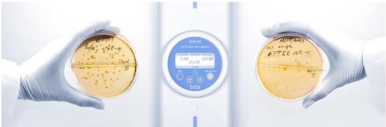
Abb. 7: Luftverschmutzung vor und nach kurzzeitigem Umluftbetrieb UVR-Mi.
