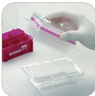
Entfernen Sie die Deckplatte mit den Spitzen und heben Sie diese aus der Verpackung.
